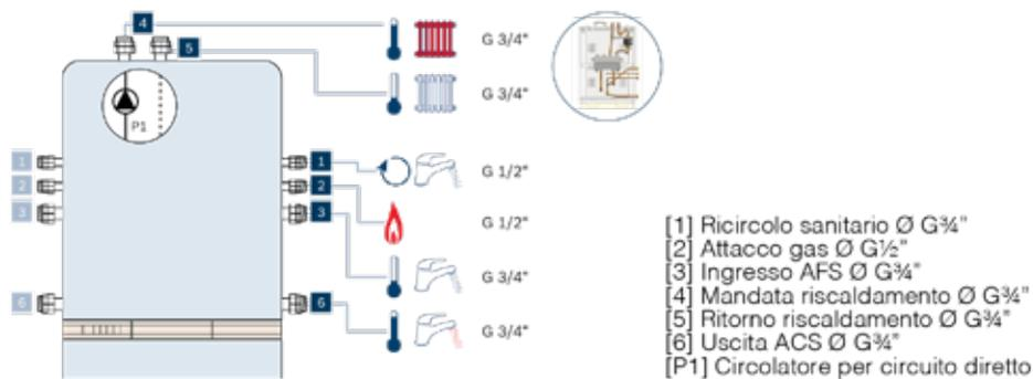
**Esempio di set di collegamento tipo CS13 (attacco orizzontale e superiore) per 2 circuiti di riscaldamento (diretto + miscelato) + separatore idraulico**
