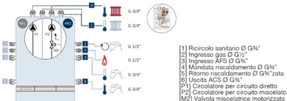
**Esempio di set di collegamento tipo CS17 (kit per adattamento connessioni idrauliche per collegamento realizzato in opera)**
