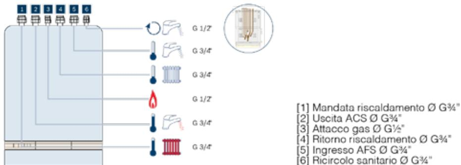
**Esempio di set di collegamento tipo CS12 (attacco orizzontale e superiore) per 1 circuito di riscaldamento + separatore idraulico**
