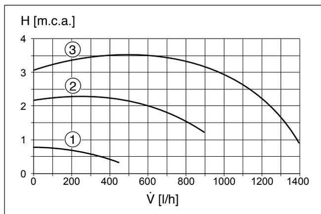
[1-2-3] Curva caratteristica con l'interruttore in posizione 1-2-3 (modulante)
