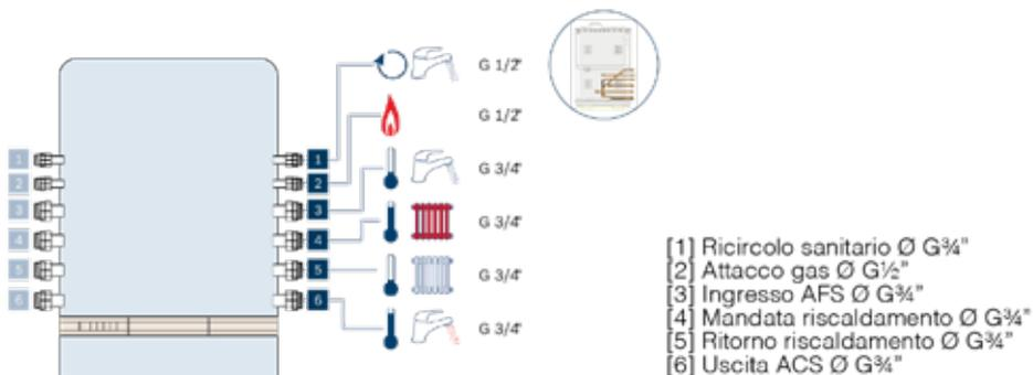
Esempio di set di collegamento tipo CS11 (attacco verticale) per 1 circuito di riscaldamento
