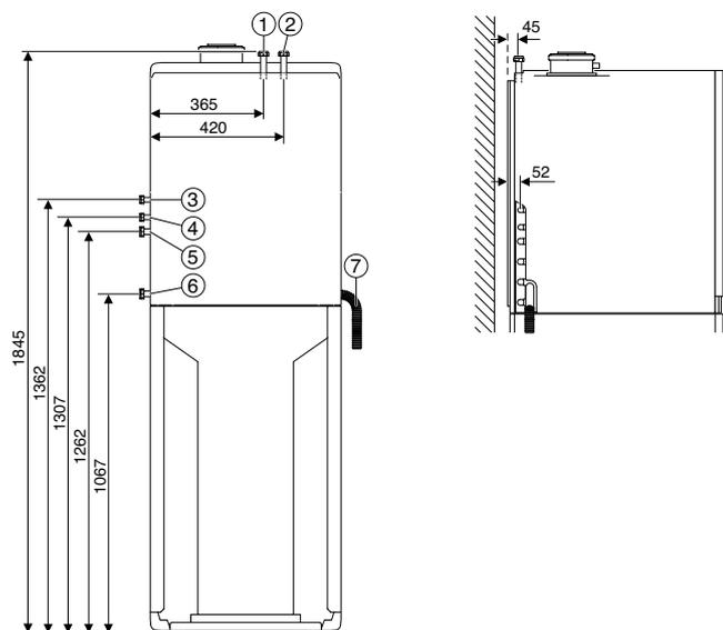
Dimensioni di montaggio con accessori di ampliamento del circuito 1 di riscaldamento
